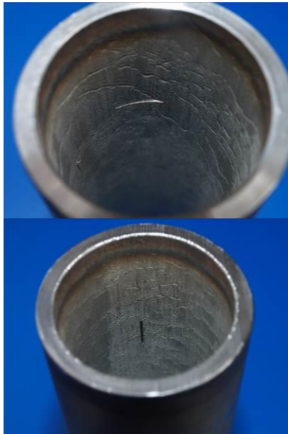
Obr. 10 Referenční vzorek s drážkami – příčná (nahore), podélná (dole)
