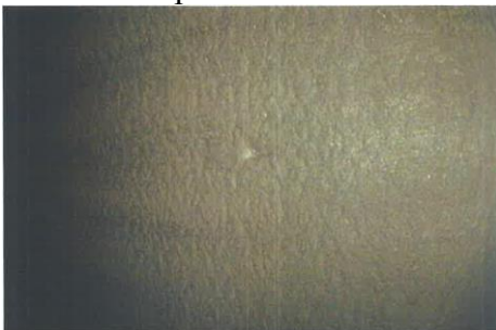
Obr. 7 Indikace zjištěné vizuální kontrolou pomocí videoskopu – vzorek 1 a 2 [7]
